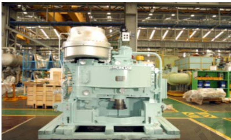
〈카고오일펌프 및 발라스트펌프〉
